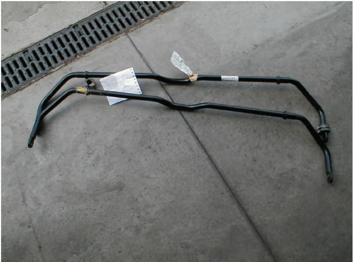
Die Bilder zeigen ganz klar am abmontierten Stabilisator, dass sich unter der Hülse Rost gebildet und diese gesprengt hat (gelb gekennzeichnet). Drüber zum Vergleich ein neuer Stabilisator.
